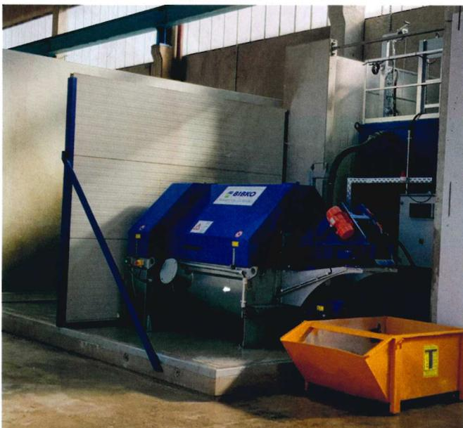
Bibko-Restbetonauswaschsystem Typ ComTec 4
