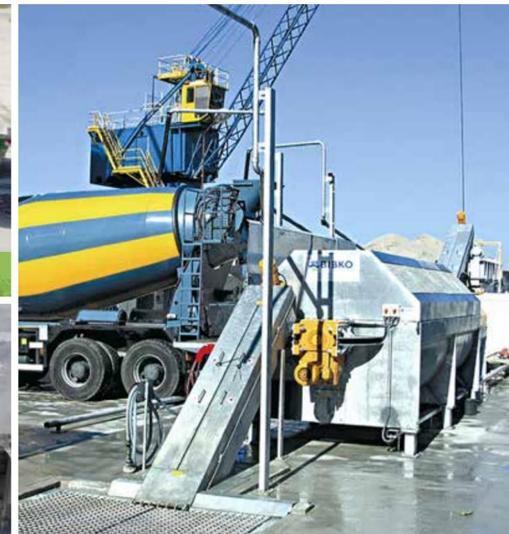
Dosierpuffer with Pumpenentleerförderer
