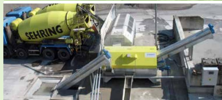
Dosierpuffer mit Pumpenentleerförderer, kombiniert mit ComTec
