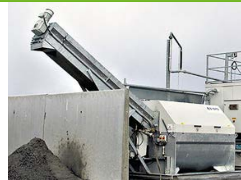
Version I: Mobile ComTec auf Stahlträger montiert Mobile ComTec skid mounted
