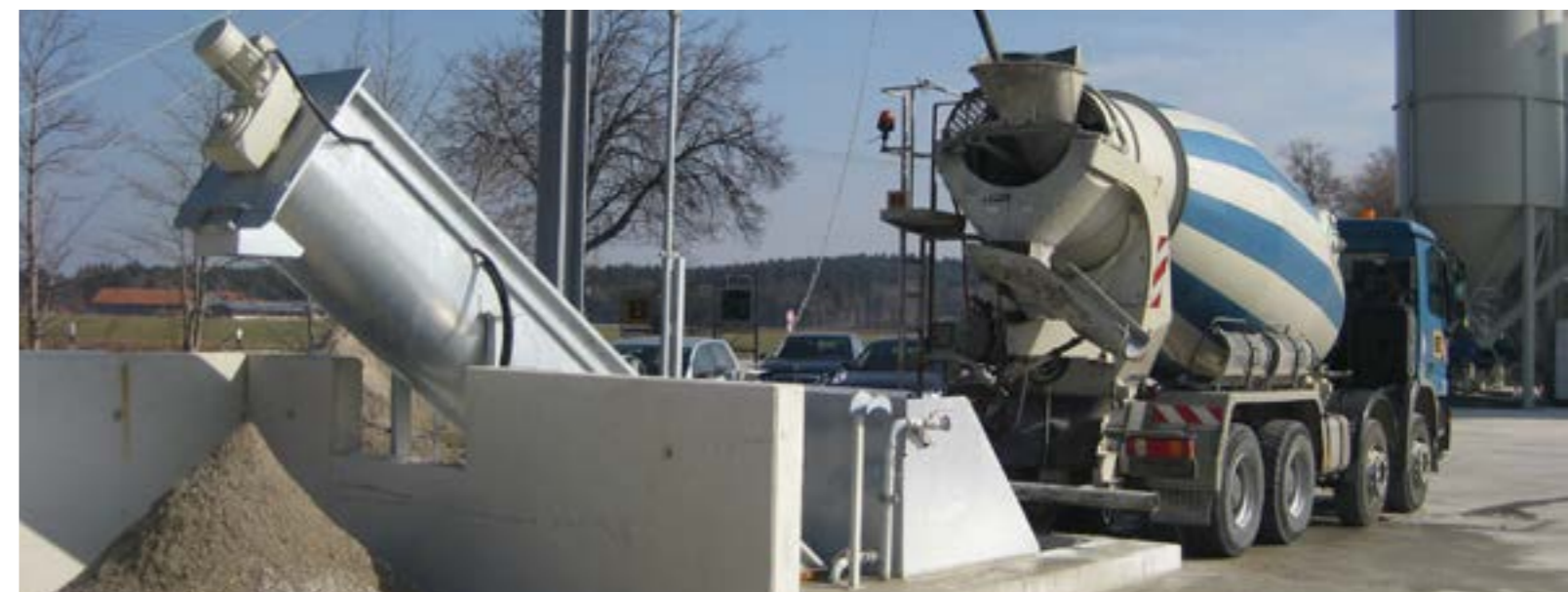
Versenkte RWS für Fahrmischer und Betonpumpen RWS set in ground for mixer trucks and pump trucks
