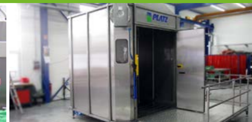
Kabinenwaschanlage Cabin washing machine
